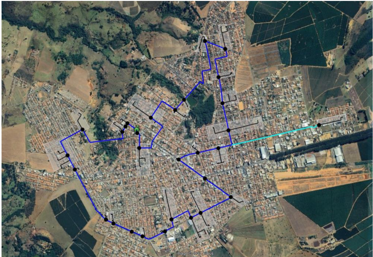
Figura 3 – Proposta de infraestrutura de fibra óptica
